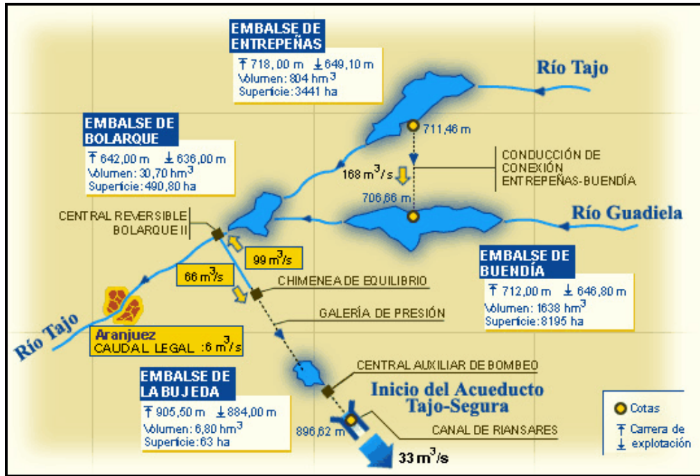
Fig. No 4.20: Esquema funcional del sistema de cabecera del acueducto Tajo-Segura
